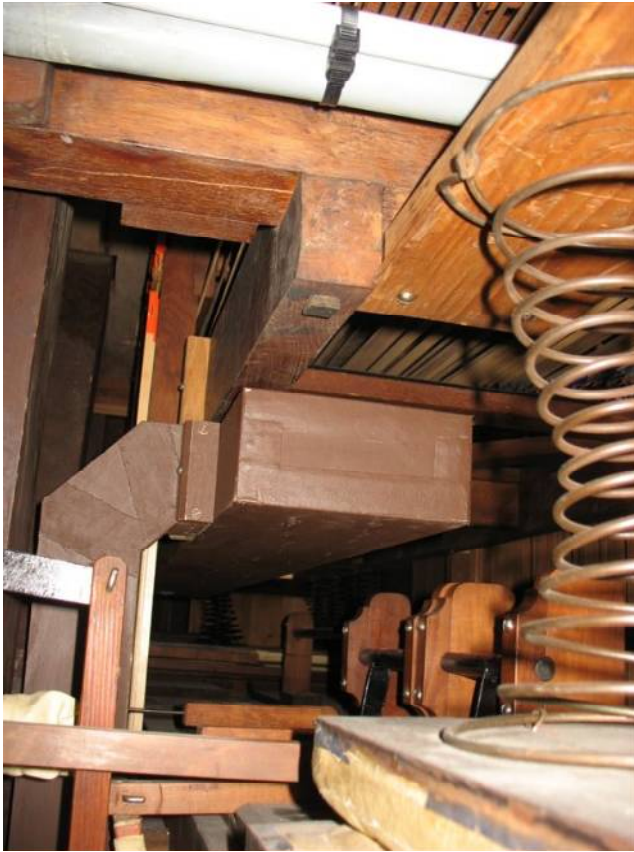
L'extrémité du nouveau porte vent d'alimentation de la Barker et son entrée dans l'ancien porte vent de la machine côté Dièse
