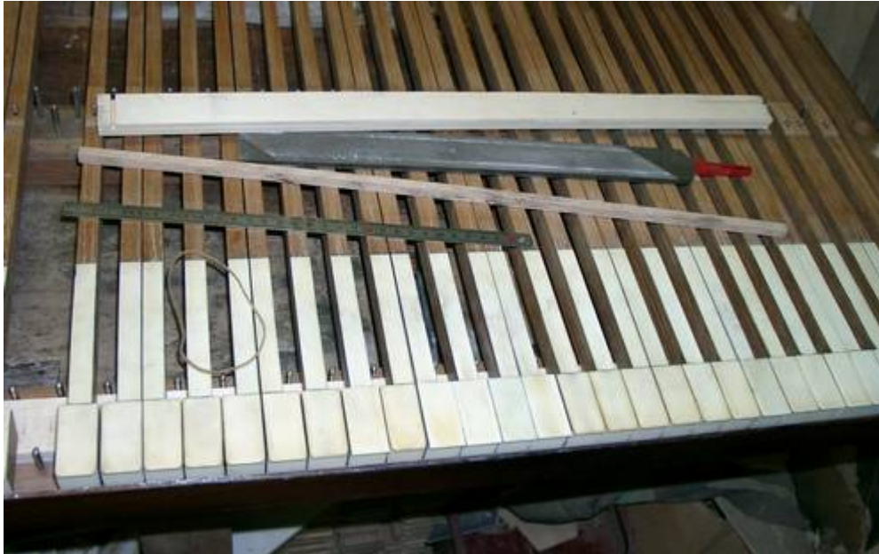
Les plaquages des touches en ivoire ont été partiellement remplacés, puis poncés et polis. Les jeux dans les mortaises ont été réduits par collage de casimir
