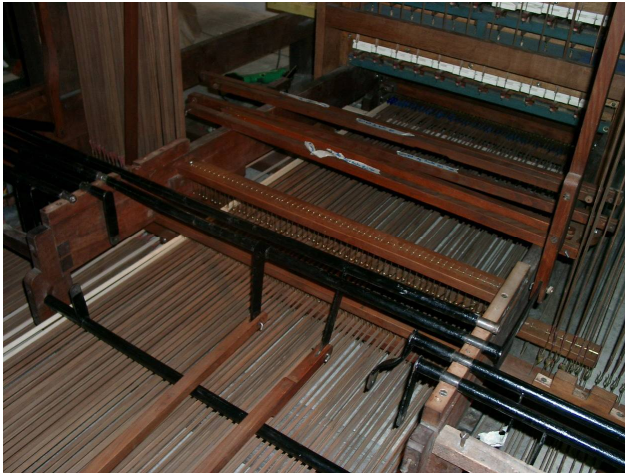
Différents éléments de la mécanique des notes en cours de remontage.
