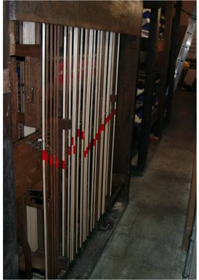
Différents éléments de la mécanique des notes en cours de remontage.
