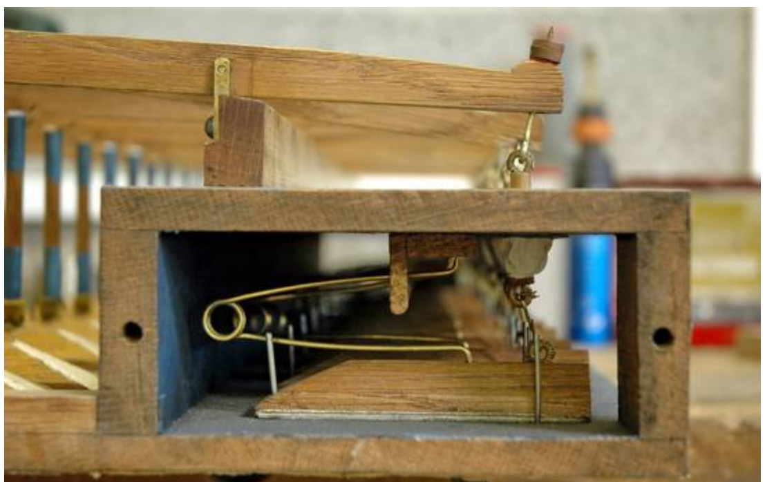
Un aperçu de toutes les pièces nécessaires au tirage d'une seule sou-pape d'admission de la Barker
