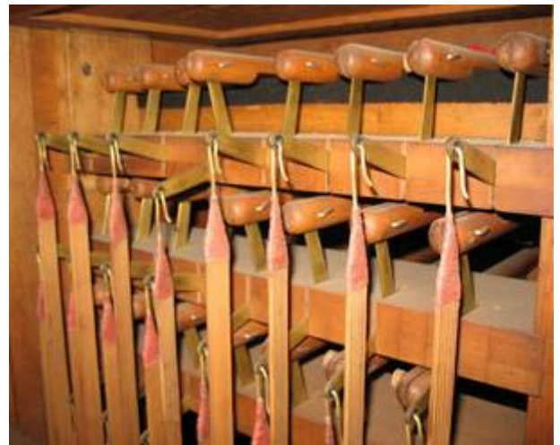
La mécanique des tirasses, vue de côté et de face
