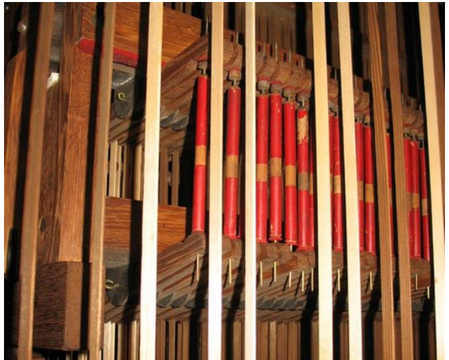
L'accouplement mécanique Récit sur Positif
