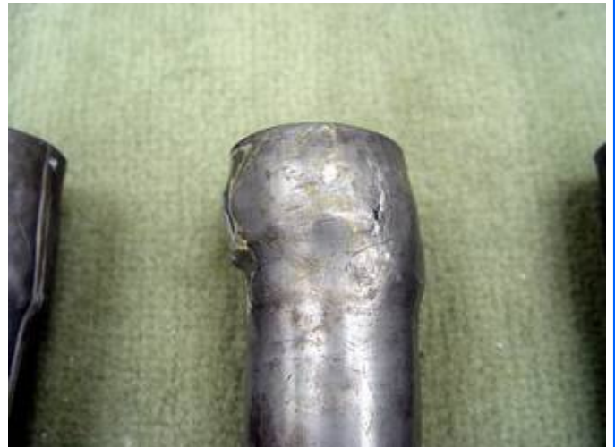
La déformation des pieds suite à l'oxydation des noyaux
