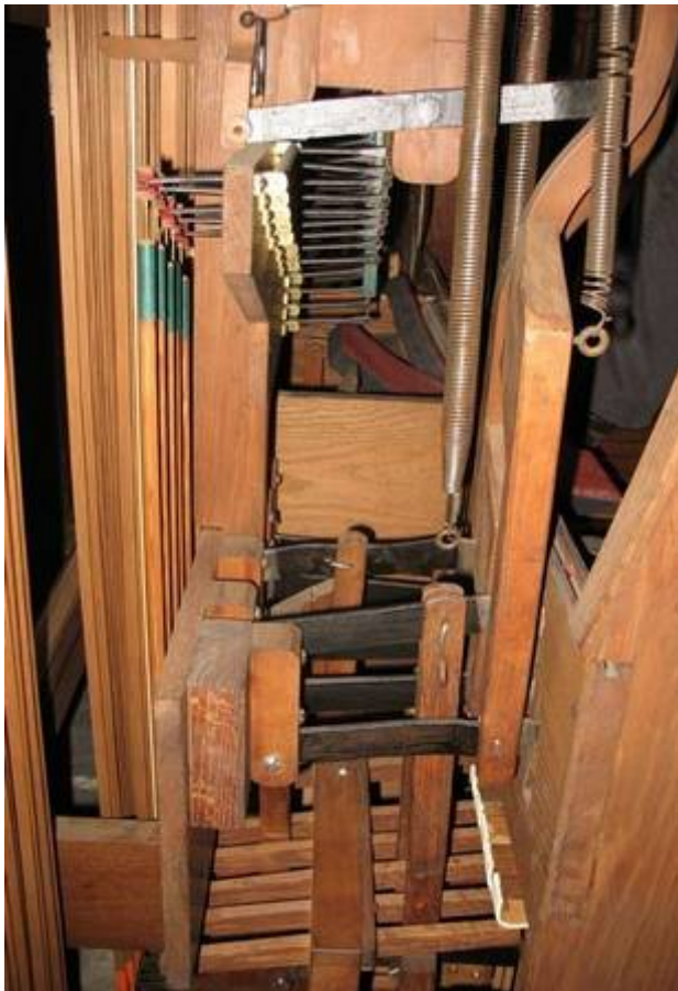
Le rouleau du Crescendo côté dièse et les équerres de tirage des jeux
