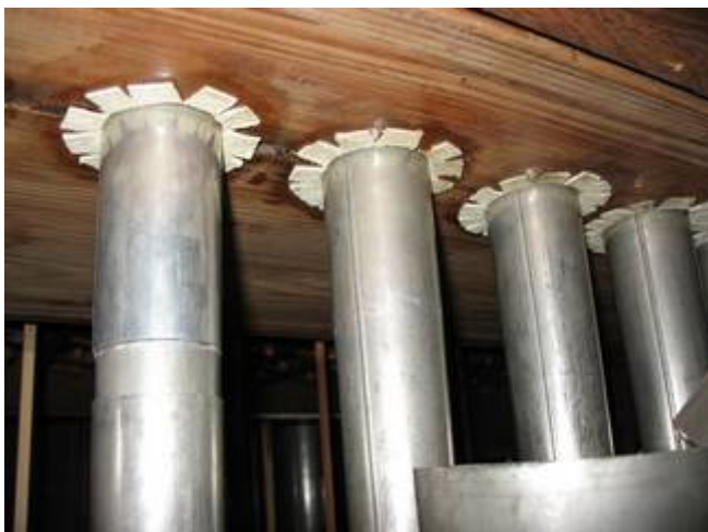
Les pavillons des basses du Basson 16 traversent le plancher d'accord des fonds du G.O.. La suite est soudée pour passer sous le sommier des aigus de pédale
