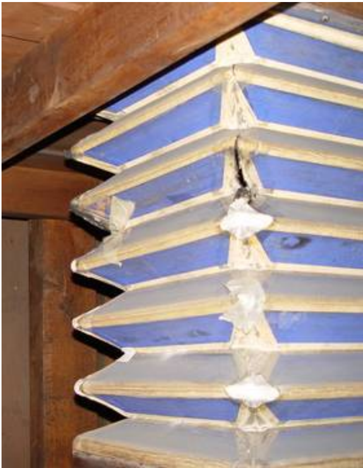
Le gosier d'alimentation entre les réservoirs côté do, au démontage avec ses déchirures et en atelier après repeaussage complet
