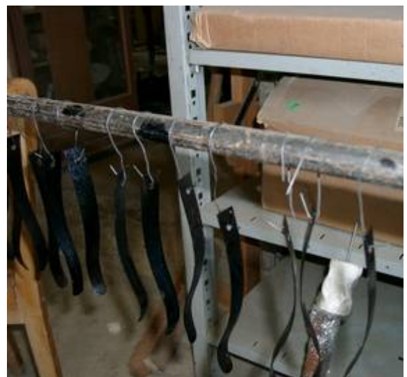
Les marches du pédalier avant les recharges de chêne, et leurs ressorts qui sèchent après avoir été désoxydés et traités à l'aide d'un mélange Huile de lin et essence de térébenthine.
