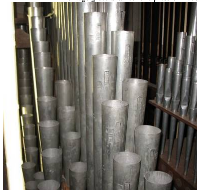
Les pavillons des basses du Basson 16 traversent le plancher d'accord des fonds du G.O.. La suite est soudée pour passer sous le sommier des aigus de pédale
