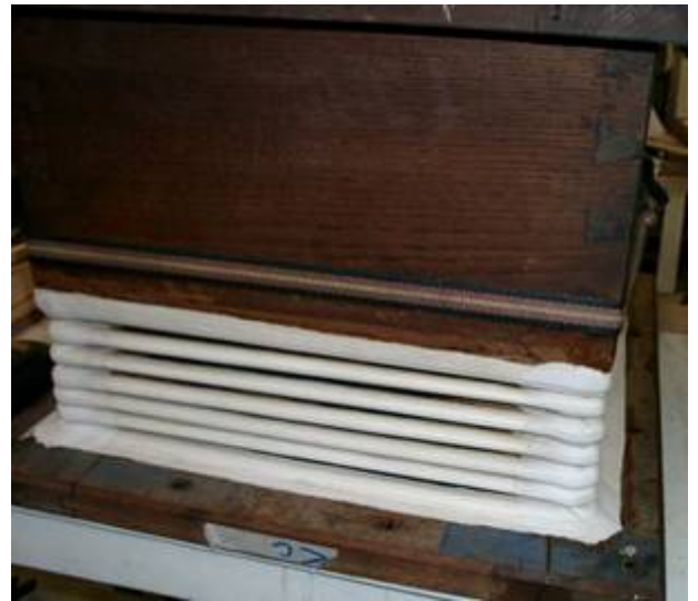
Le gosier d'alimentation entre les réservoirs côté do, au démontage avec ses déchirures et en atelier après repeaussage complet
