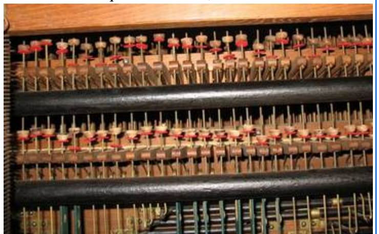
La mécanique des tirasses, vue de côté et de face
