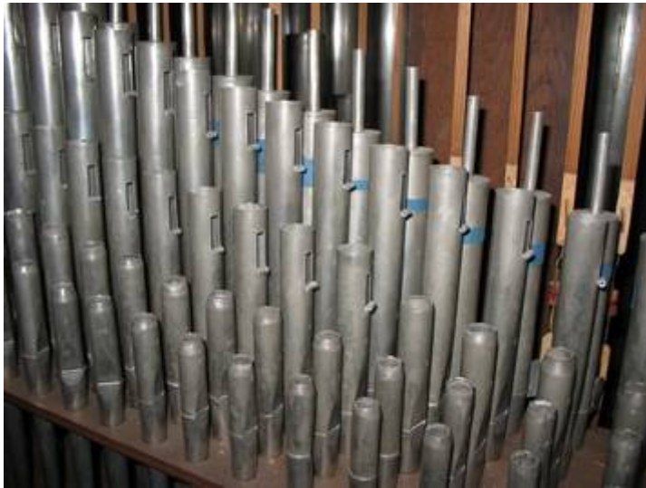
Les tuyaux du Cornet et du Plein Jeu du Grand-Orgue, un peu moins fermés qu'au démontage grâce à la nouvelle pression reconstituée (115 mm)
