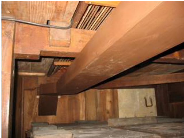
Le nouveau porte-vent passe sous la mécanique du G.O. et au dessus de l'antiscousse
