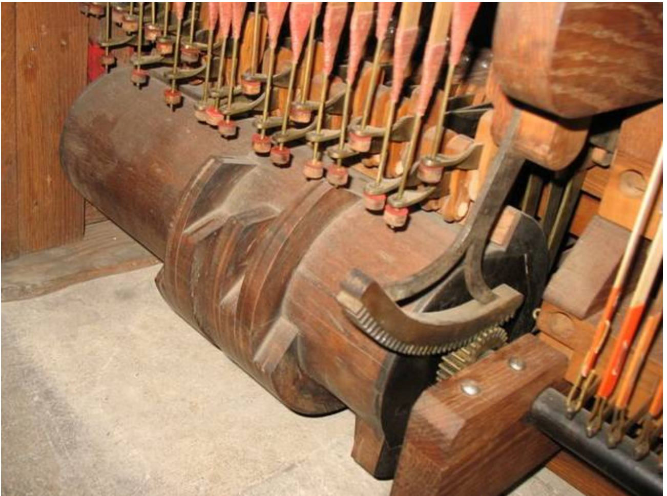
Le rouleau du Crescendo côté dièse et les équerres de tirage des jeux
