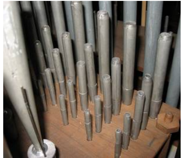
Les tuyaux du Cornet et du Plein Jeu du Grand-Orgue, un peu moins fermés qu'au démontage grâce à la nouvelle pression reconstituée (115 mm)
