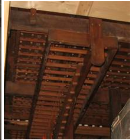
La mécanique du Récit et le réservoir complémentaire de ce plan sonore
