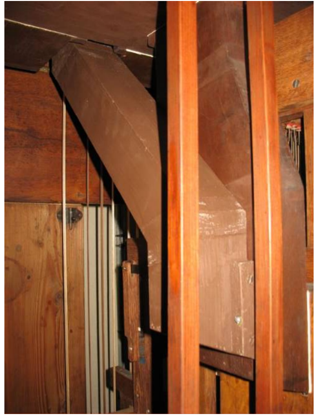
L'extrémité du nouveau porte vent d'alimentation de la Barker et son entrée dans l'ancien porte vent de la machine côté Dièse
