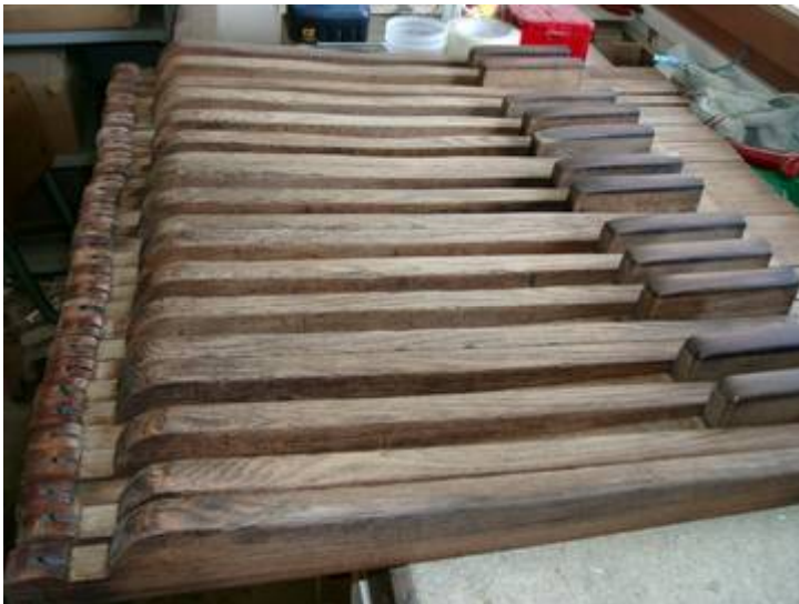
Les marches du pédalier avant les recharges de chêne, et leurs ressorts qui sèchent après avoir été désoxydés et traités à l'aide d'un mélange Huile de lin et essence de térébenthine.
